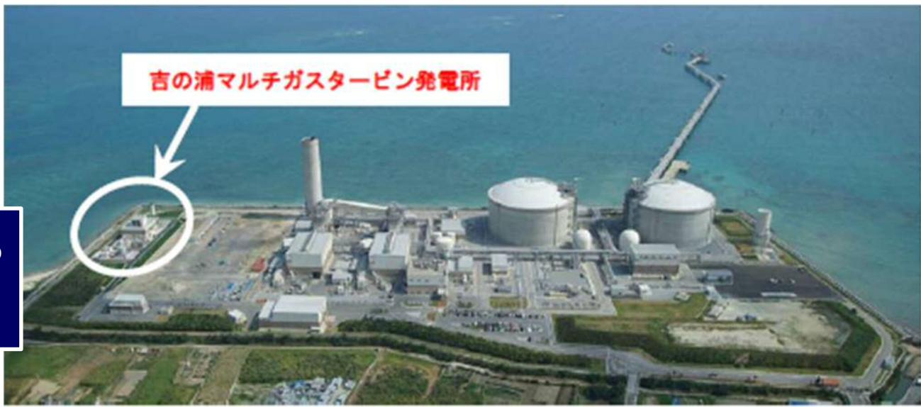
他地域、島嶼部への展開も期待できる数万kW級ガスタービンでの水素利活用を目指し、パイロットケースとして**水素混焼**化し、**実商用系統接続下での燃焼試験**を行う。
