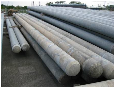
コンクリート柱
