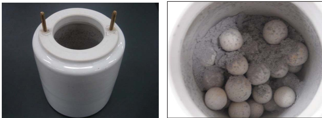
図 2-16 卓上型ボールミル (1500mL) とその内部
