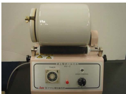
図 2-15 卓上型ボールミル（左）、処理後の基質（右）
