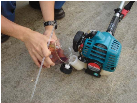
図 4-5 E 3 燃料を草刈り機に投入（左）し、エンジン始動を確認（右）
