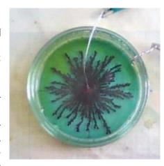
と溶液の電気抵抗が大きくなるために枝が伸長しにくくなって中心部から銅が析出し、銅樹が「ウニ型」になるが、濃度が大きいと溶液の電気抵抗が小さくなるので銅樹が「枝型」になると考えられる。
