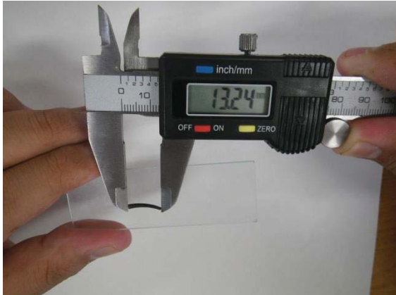
写真14 筒巢長測定（デジタルノギス使用）
