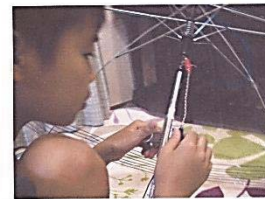
導線を目玉クリップで傘の軸にはさむ時
