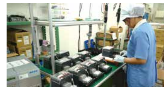
スマートメーター計量器の誤差試験
