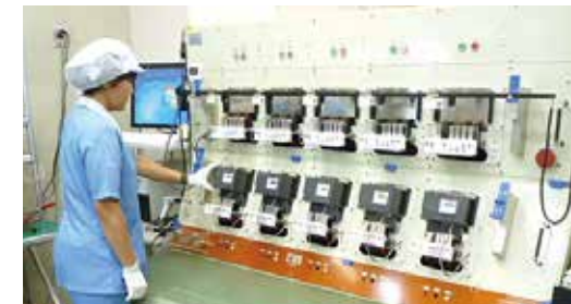
スマートメーター計量器の誤差試験
