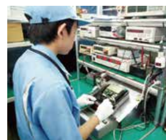
▲電子式電力量計の修理
