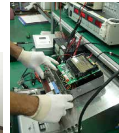
電力需用複合計器修理
