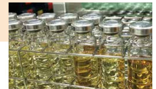
油中ガス分析(変圧器絶縁油)
