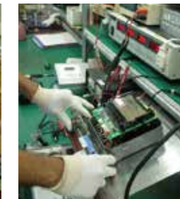
電力需用複合計器修理
