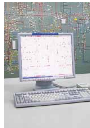
配電自動化システムの操作卓
