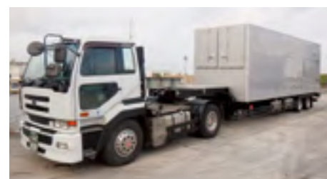
移動用発電設備
