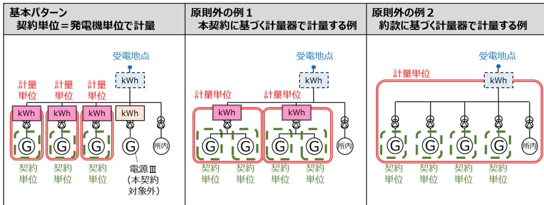
kWh … 託送供給等約款に基づく計量器 (発電量調整契約の精算用)
