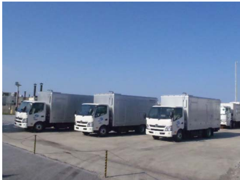
移動用発電設備（ディーゼル） 外観①
