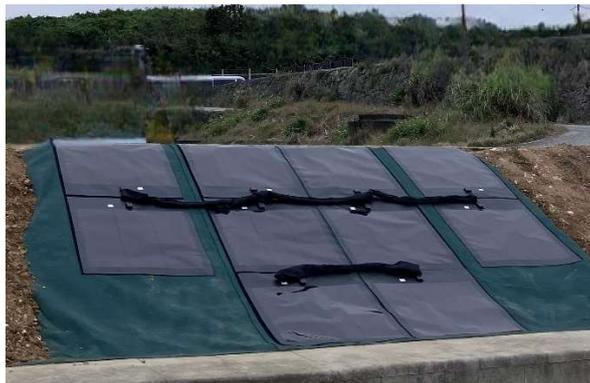
(写真2) 設置完了したフィルム型ペロブスカイト太陽電池
