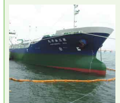
燃料油受入時のオイルフェンス展開
