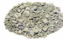
石炭灰の土木分野への活用（頑丈土破碎材※）
