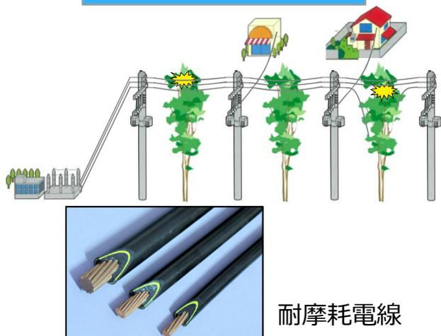
樹木接触到強く、摩耗による断線を防止。
