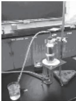
図4 簡易蒸留装置
