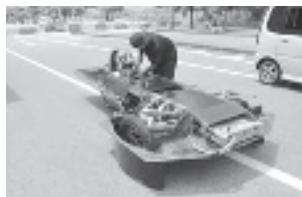
私たちは車両の基幹部位に、主たる素材としてカーボンファイバーを使用した。一般的に CFRP とも呼ばれる。ノーメックスハニカムをカーボンファイバーで挟むサンドイッチ構造の板材を地域企業の協力を得て自分たちの手で熱処理成型し、フォーミュラーカーと同様なコンポジットモノコック構造の車両を製作した。
