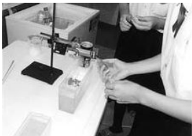
図4 水槽の水を3カ所着色する
