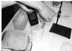
図3 寒剤の温度を測定する(-23.3℃)
