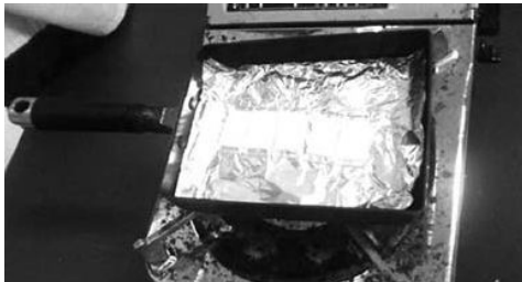
写真4：酸化チタンペーストを加熱する
