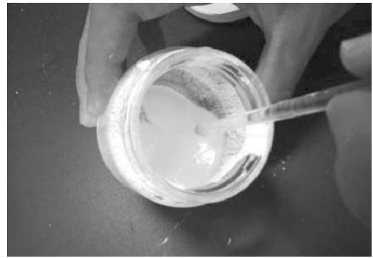
写真1：ガラス瓶の中で酸化チタンとエタノールを混ぜる。
