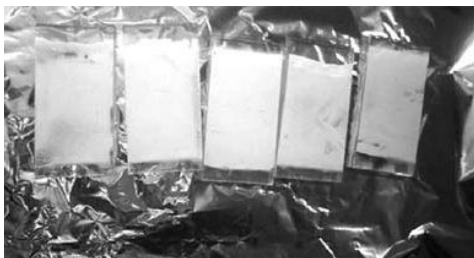
写真5：酸化チタンが加熱途中で赤っぽくなる
