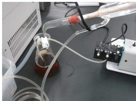
図 4-1 バイオリクター装置 (左) 循環している糖化液 (右)
