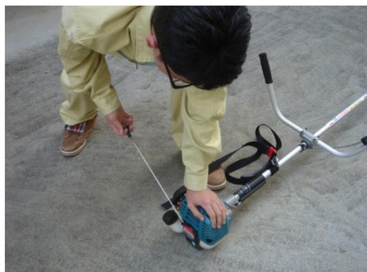
図 4-5 E15 燃料を草刈り機に投入（左）し、エンジン始動を確認（右）
