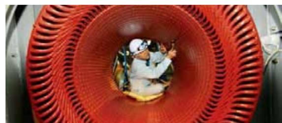
▲電動機の固定子点検
