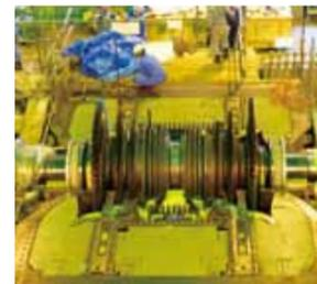
▲長寿命化対策工事を行った石川火力発電所2号機の蒸気タービン
