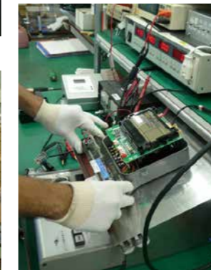
電力需給用複合計器修理
