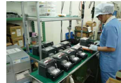
・QRラベルの作成及び貼付 ・計量部、通信ユニット、端子ブロック、端子カバーの組立
