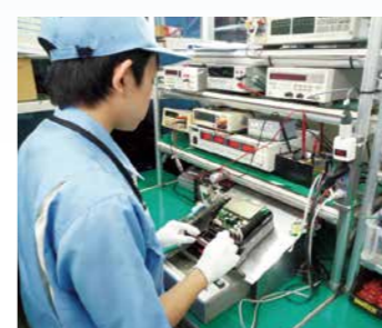
▲電子式電力量計の修理
