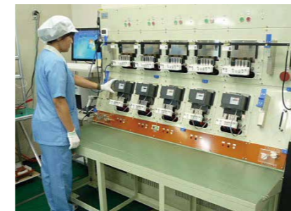
スマートメーター計量器の誤差試験
