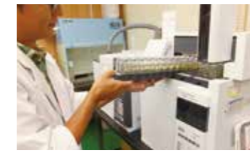
油中ガス分析 (変圧器絶縁油)
