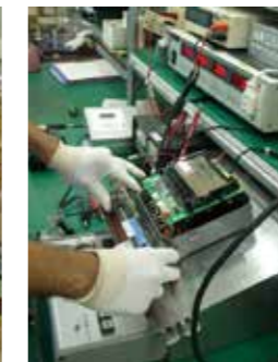
電力需用複合計器修理
