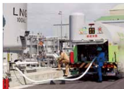
天然ガス供給センターへの荷卸し作業の様子
