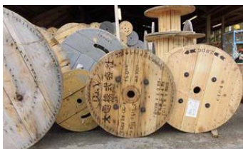
電線ドラム（木製）の回収・再使用
