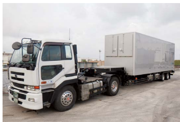
▲移動用発電設備
