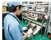
電子式電力量計の修理
