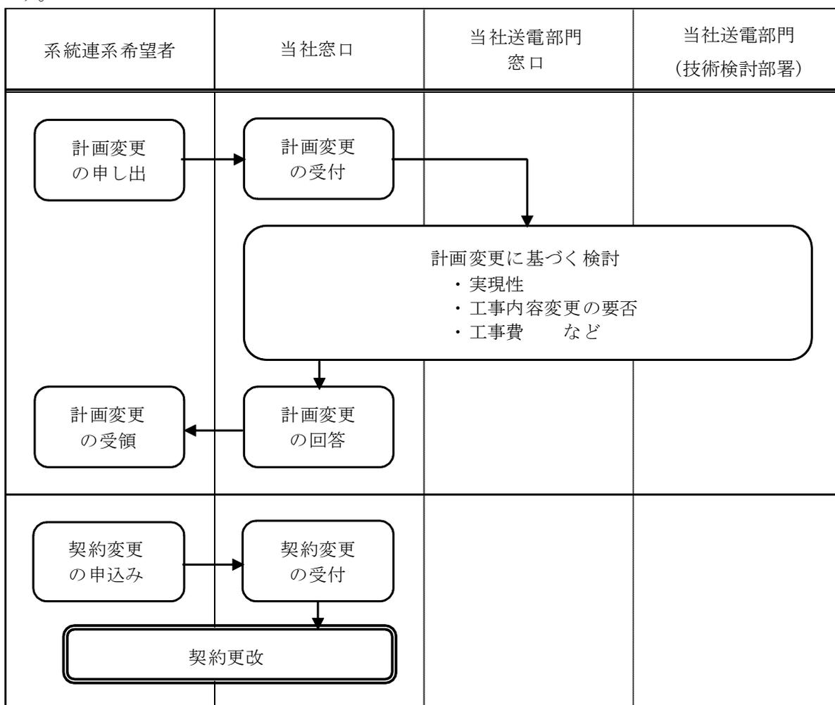
図8 系統連系希望者が計画変更を申し出た場合の業務フロー
