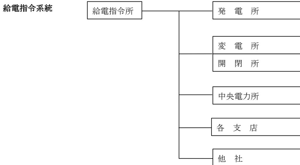
—— : 機器の運転、潮流の調整、開閉操作、送配電線路および変電設備の非常巡視
