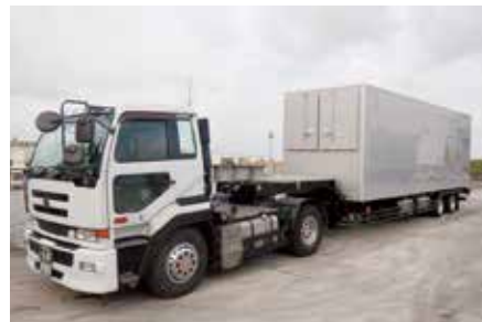
▲移動用発電設備
