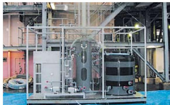
▲CO<sub>2</sub>化学固定法のパイロット試験装置
